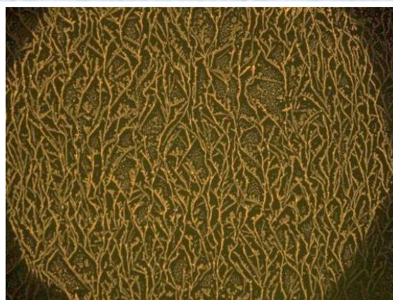
金属錯体の結晶の蛍光顕微鏡写真。均一な結晶化が出来た。
